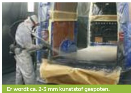
Bij een lage behandeling voor de Kangoo spuiten we de vloer en een paar centimeter rondom.
