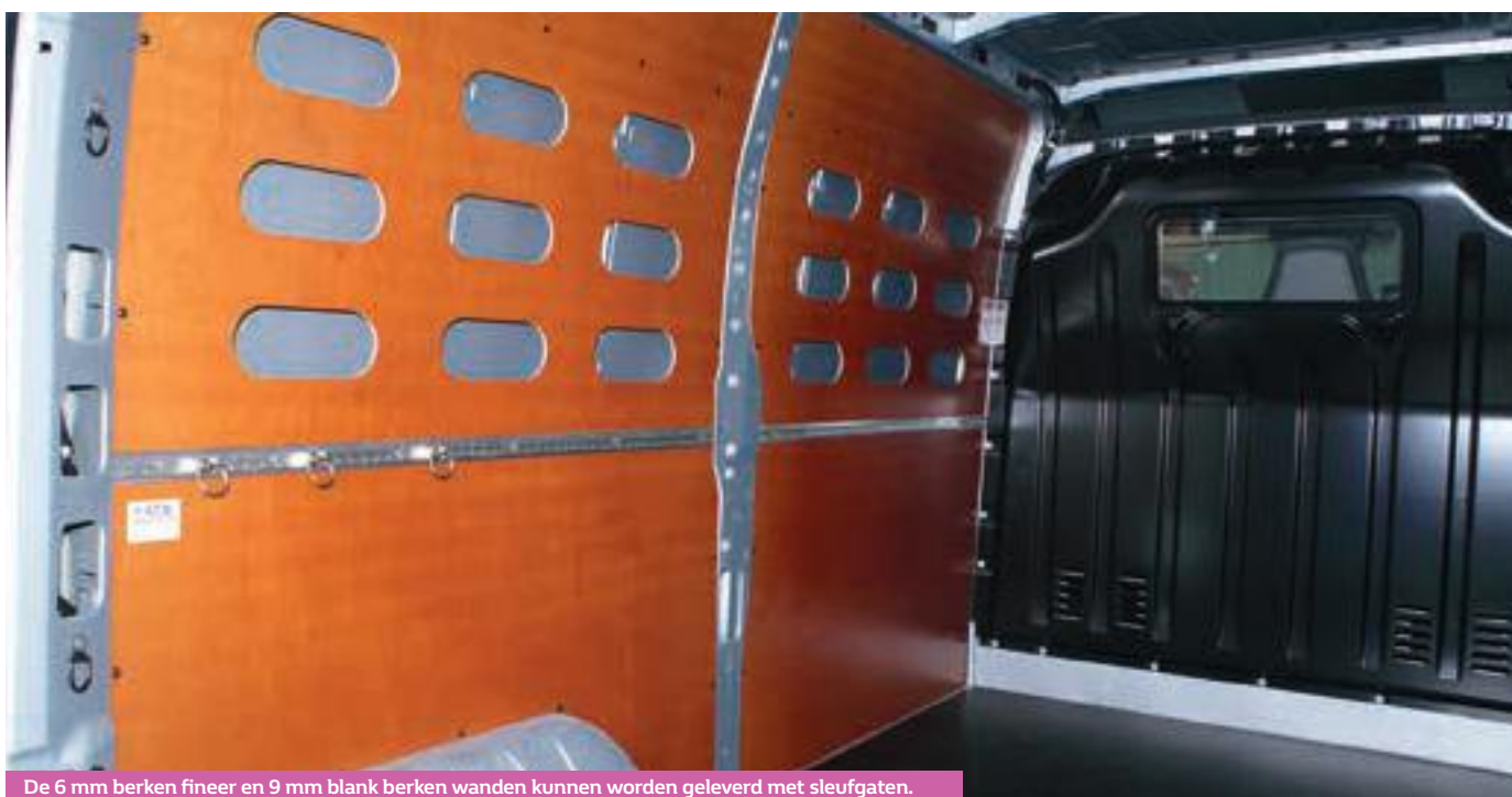
De 6 mm berken fineer en 9 mm blank berken wanden kunnen worden geleverd met sleufgaten.
