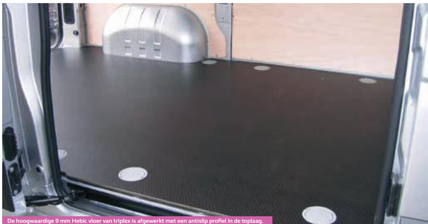
De hoogwaardige 9 mm Hebic vloer van triplex is afgewerkt met een antislip profiel in de toplaag.
