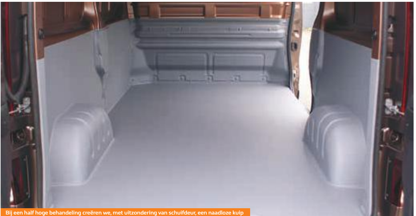
Na het spuiten wordt alles hermonteerd.
