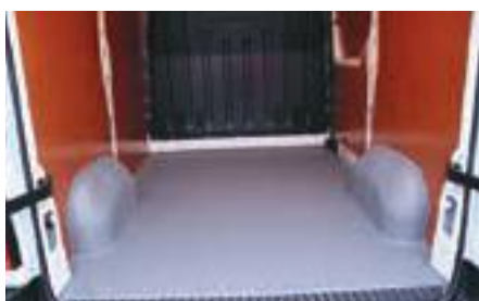
Turbo Liner® is antislip en slijtvast.
